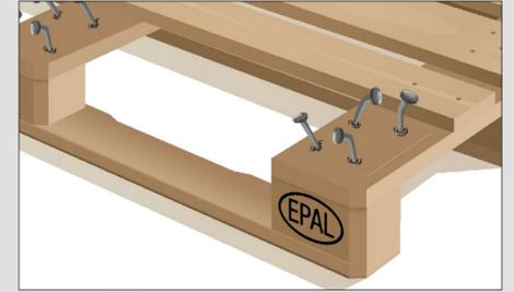
Un dé est manquant ou fendu de telle sorte que plus d'une tige de pointe est visible.
